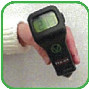
1. Laissez le déviateur de flux en place; agitez dans l'air.
