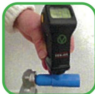
5. Connectez le Quick-Ox à la sortie du bloc de plongée.
