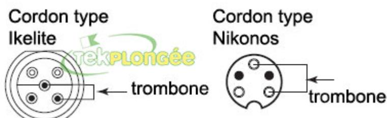
Pour les cordons IKELITE : placer le trombone entre le trou central et le trou inférieur droit (voir figure) pour faire le shunt. Le flash doit se déclencher.
