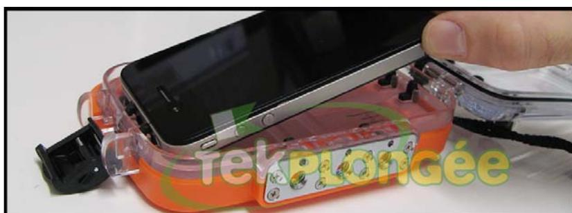
3. Refermer la porte arrière jusqu'à ce que le joint de porte soit bien en place dans le caisson.
