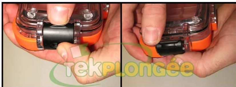
2. Placer l'iPhone dans le caisson de manière à ce que la lentille de l'appareil photo soit alignée avec le caoutchouc souple noir du déflecteur. Les bords de l'iPhone doivent reposer sur les petits plots en caoutchouc noirs anti vibration.
