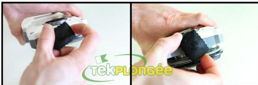
2. Placer le S4 dans le caisson de manière à ce que la lentille de l'appareil photo soit alignée avec le caoutchouc souple noir du déflecteur. Les bords de Galaxy S4 doivent reposer sur les petits plots en caoutchouc noirs anti vibration.
