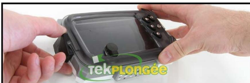
4. Refermer le caisson en tournant la poignée de verrouillage dans le sens des aiguilles d'une montre jusqu'à ce que le loquet de verrouillage s'enclenche fermement en position verrouillée (Click)
